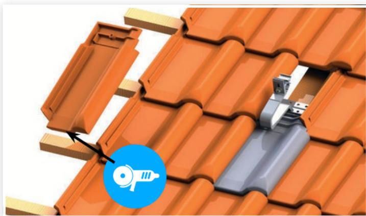
Allineare i ganci per tegole utilizzando una corda nella direzione orizzontale e fissarli con 2 viti a testa larga nei travi. Assicurarsi che in ogni fila di fori venga inserita una vite.
