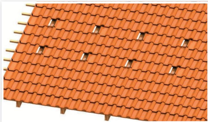
Fai attenzione anche alle aree di fissaggio del modulo, che dovrai prendere dalla guida di installazione dei moduli utilizzati.
